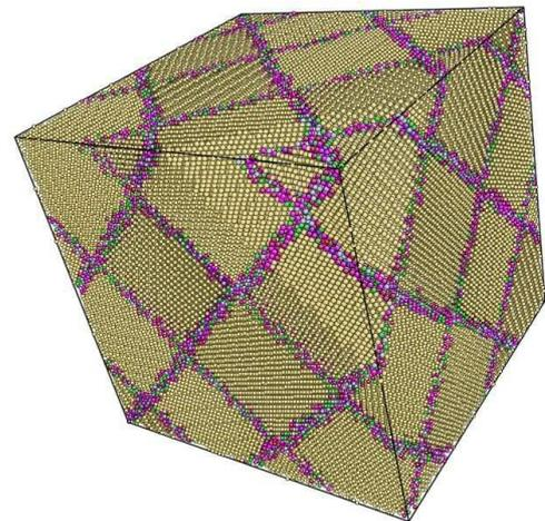
Nanostructures copper: Visualisation of grains
